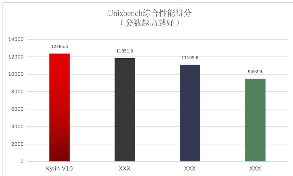
图 2-4 Unixbench 综合性能测试 (Hygon C86 7390)
