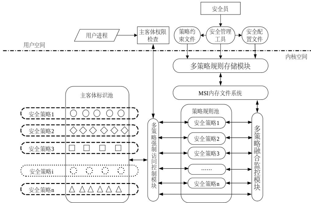
图 2-9 多策略融合控制总体流程
